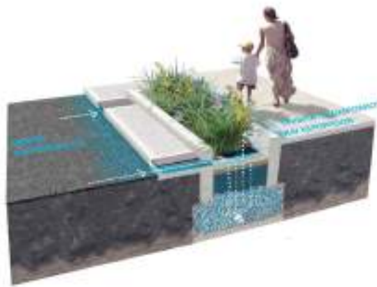
Σχηματική αναπαράσταση της λειτουργίας των παρτεριών βιοκατακράτησης (Από: Σωτηριάδης 2014 )
